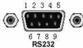
图 3-14 微机通讯接口连线
