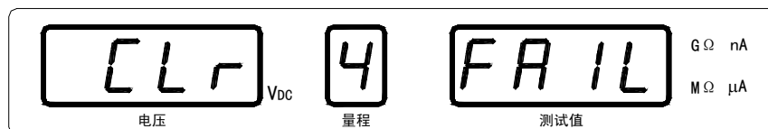
图 3-11 清零校准失败，显示 FAIL
