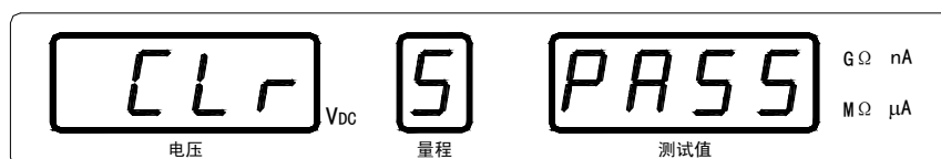
图 3-10 清零校准成功，显示 PASS
